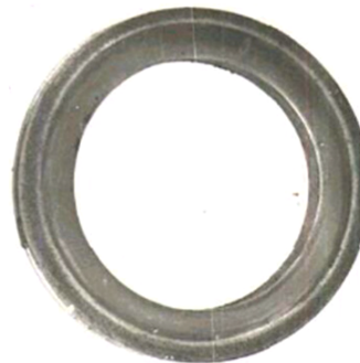
Рис. 2 – Нерухома шайба металевго ущільнення
