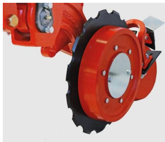
Рис. 1. Сошник сівалки Gigante виробника GASPARDO
