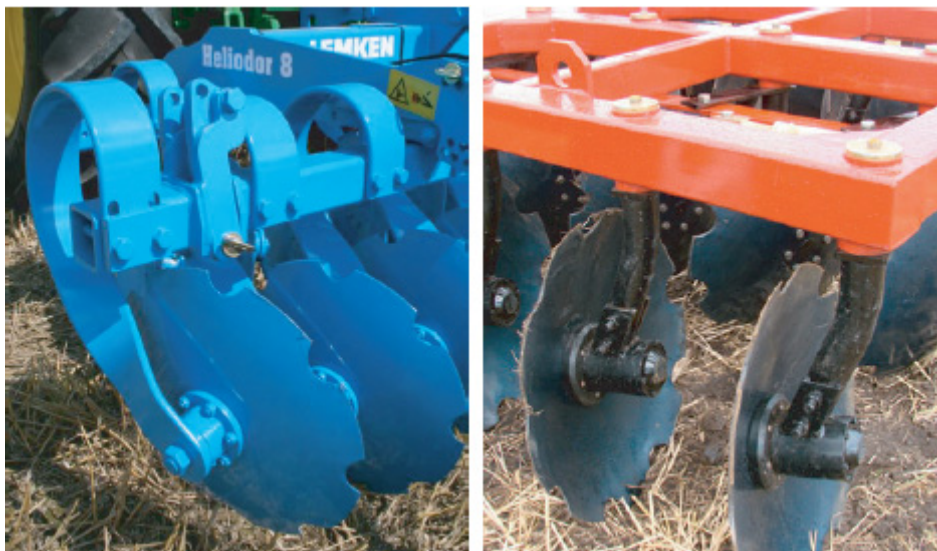
Рис. 1. Варіанти виконання стояків корпусів: а – пружний стояк; б – жорсткий стояк
