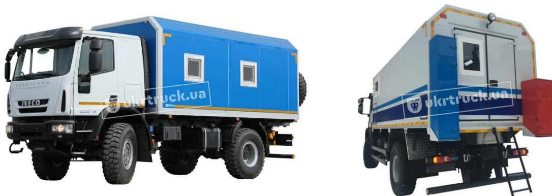
Рисунок 2.19 – Ремонтно-діагностична майстерня AVTR-АП42V4402 на шасі автомобіля-фургона Iveco з комплектом необхідного обладнання
