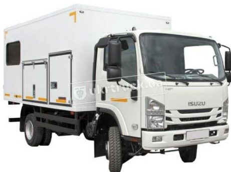
Рисунок 2.27 – Пересувна оливозаправна станція АП25Z4206-OS на базі шасі ISUZU NP R75LH
