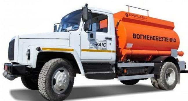
Рисунок 2.28 – Пересувна механізований заправний агрегат АПЗ-4,9 на базі шасі ГАЗ-3309
