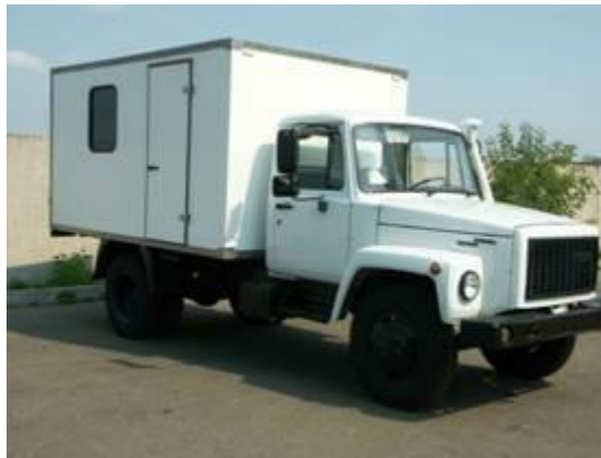
Рисунок 2.22 – Ремонтна майстерня МПР-9924 на базі автомобіля ГАЗ-3309 з необхідним обладнанням
