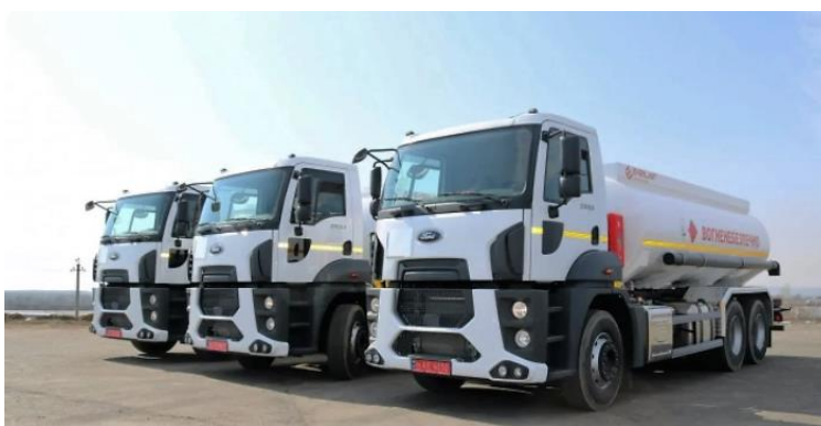
Рисунок 2.29 – Бензовоз на базі шасі Ford Cargo 2526
