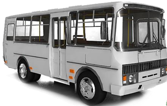
Рисунок 2.21 – Пересувна спеціальна лабораторія ВМК-3033-05-2 на базі автобуса ПАЗ-32053
